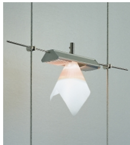
Strahler Attila mit Dekoschirm Nova Fassung GU 5,3 für Leuchtmittel QR-CB 51, max. 50 W, Spurbreite bis 25 cm
