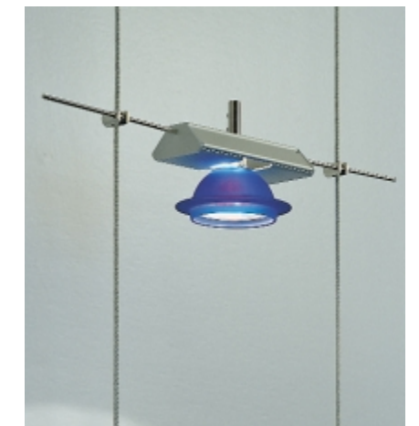
Strahler Attila mit Glasschirm Saturn Fassung GU 5,3 für Leuchtmittel QR-CB 51, max. 50 W, Spurbreite bis 25 cm
